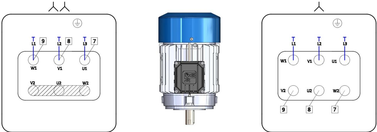
马达连接于电源230V (YY)。若要将连接从230V (YY) 转至460V (Y)，拔下连接U2, V2, W2的跳线，只移动3条线一分别为标示7号(紫色线)、-8(灰色线)、-9(白色线)-从U1、V1、W1到W2、U2、V2。为端子U1、V1、W1供电。如要改变运转方向，反转两个电源的相序。要将电源从3~460V(人)更改至3~230V(人人)，请按照与上述相反的过程。
